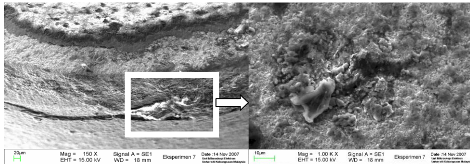
Rajah 4: Haus rekatan yang berlaku pada pinggir mata alat pada kelajuan pemotongan 146 m/min, kadar suapan 0.20 mm/gigi, ukur dalam pemotongan 1.00 mm dan menggunakan bendalir minyak sepenuhnya pada akhir hayat mata alat pada 5.91 minit.
